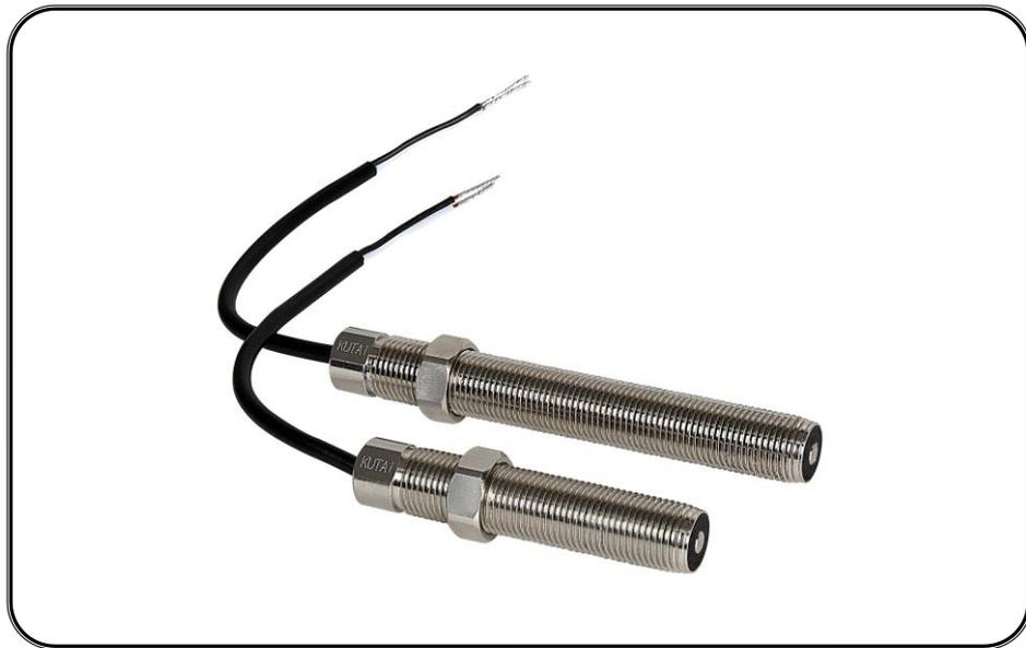
用於監控原動力的轉速。當一導磁性物體(常為發電機起動齒輪)經過時 MPU 的末端會產生一磁場變化,使 MPU 內部感應一電壓信號而這個電壓的頻率做為輸入到速度控制的信號,能準確地測量出原動機的速度。
